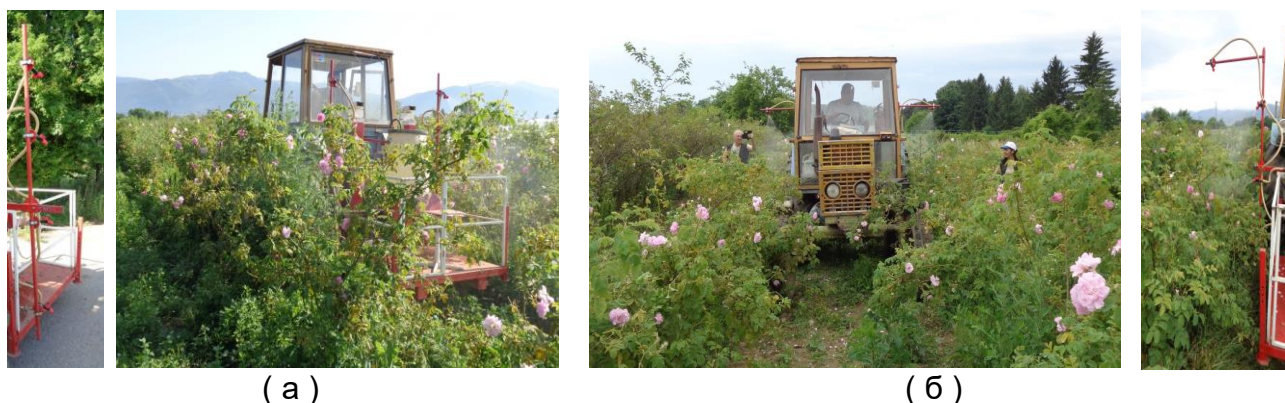
Фиг. 4.11. Машинно-тракторни агрегати на базата на ММР с щангови уредби за опръскване на розовите храсти а - с прави щанги; б - Г-образни щанги.
