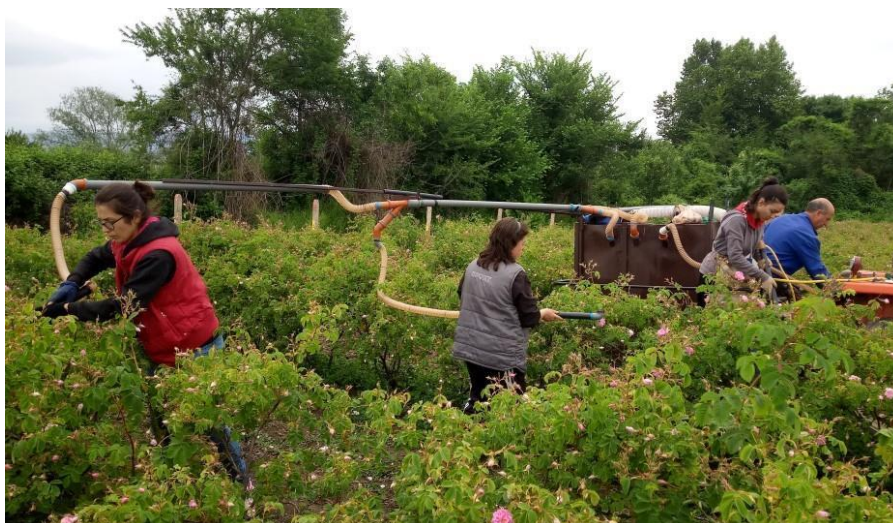
Фиг. 7.3. Експериментално изпитване в полеви условия на триредовия вариант на машината за бране на рози
