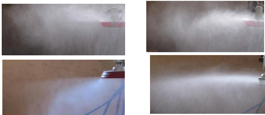
Фиг. 4.19. Характер на факела при напускането му на периферията на различни ротационни разпръскачи
