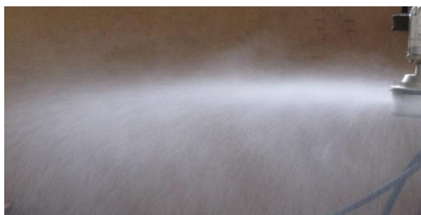
Фиг. 3.2. Общ вид на факела при работа с барабанен разпръсквач
